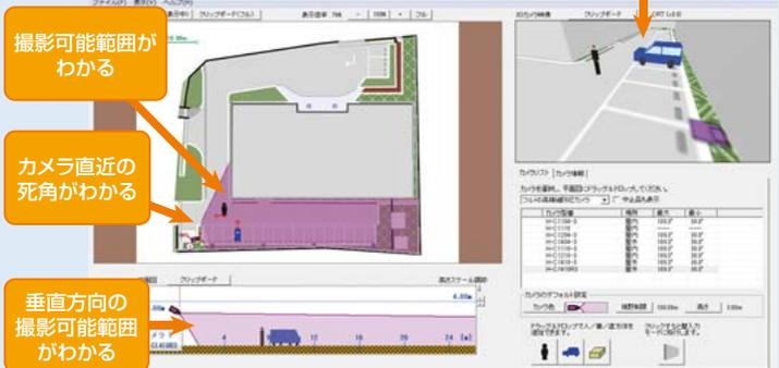
カメラの見え方が3Dシミュレーション画像でわかる
